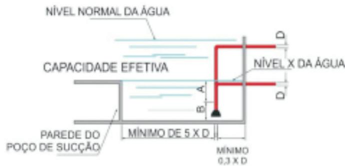
Figura B.1 - Tomada superior de sucção para bomba principal
