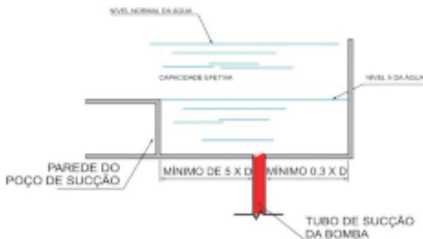
Figura B.3 - Tomada interior de sucção para bomba principal
