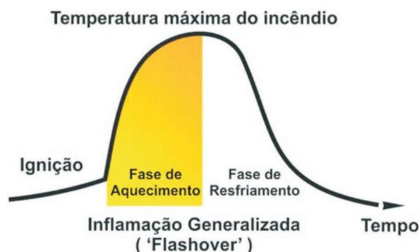
Figura 3 - Curva temperatura tempo de um incêndio
