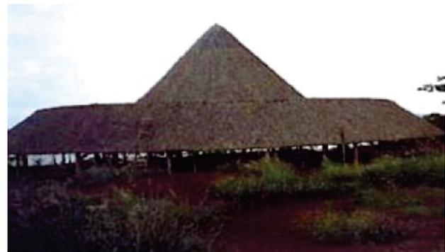
**Figura 1** - Edificação de madeira com cobertura de fibras vegetais
