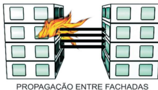
Figura 13 - Isolamento por distância de afastamento
