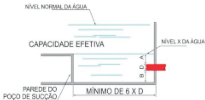
Figura B.2 - Tomada lateral de sucção para bomba principal
