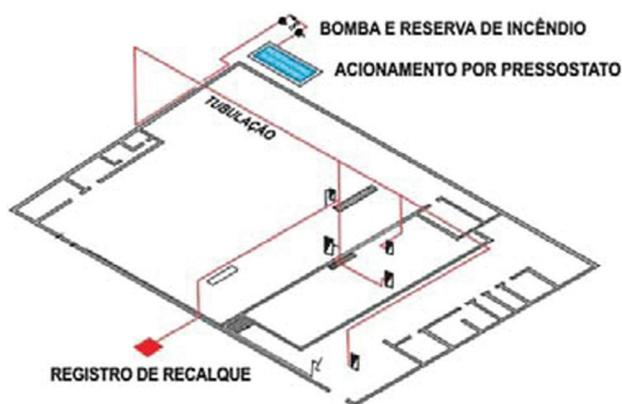
Figura 42 - Isométrica de sistema de hidrantes
